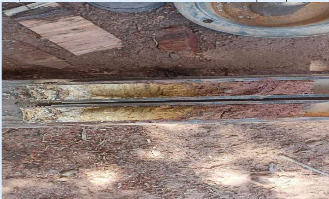
SPT-01: Areia siltosa amarela e areia siltosa avermelhada com presença de umidade
