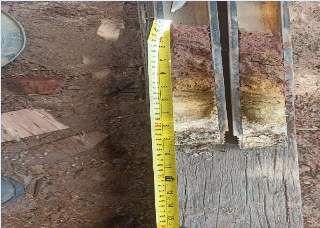
SPT-02: Areia siltosa amarela e areia siltosa avermelhada com presença de umidade
