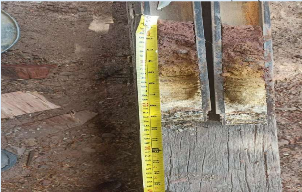
SPT-02: Areia siltosa amarela e areia siltosa avermelhada com presença de umidade
