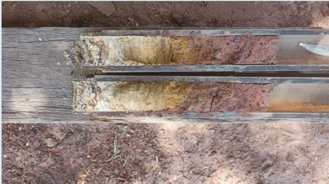
SPT – 01: Areia siltosa amarela e areia siltosa avermelhada com presença de umidade
